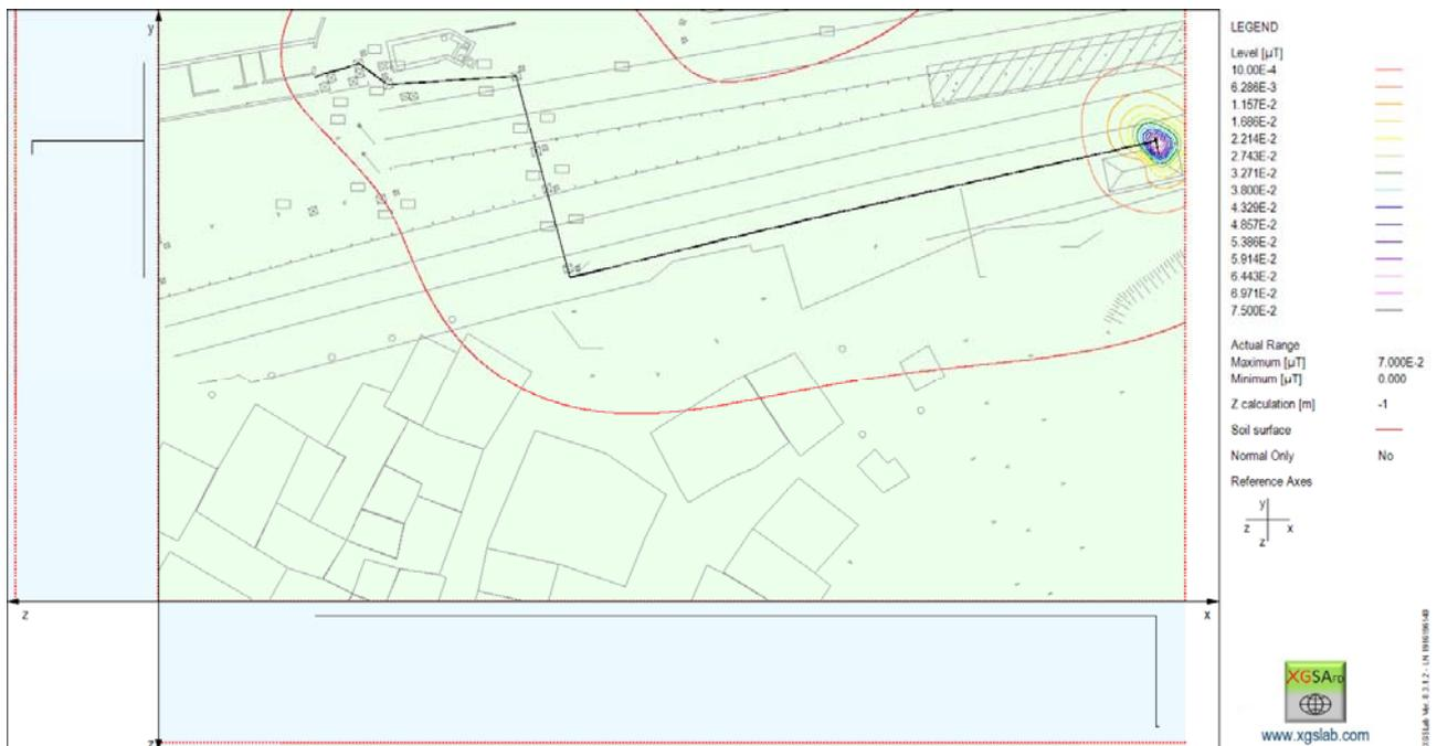
Fig. 6-3: Campo magnetico ad 1 m dal suolo a livello cabina – in rosso curva del campo a 1 nT
