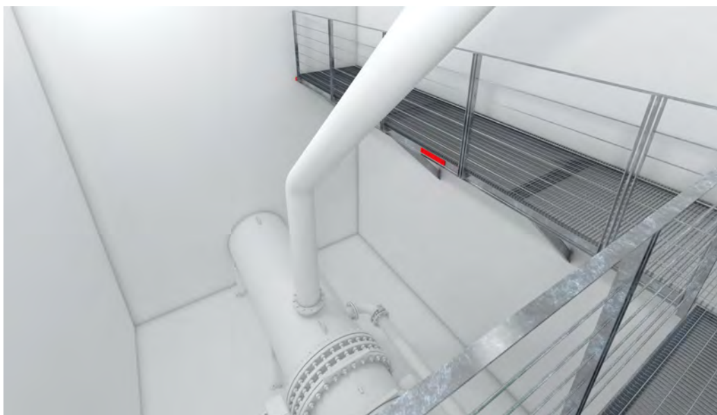
Figura 12.10: Vista assometrica della camera valvole. In primo piano la valvola di guardia condotta e lo sfiato. Sullo sfondo la passerella metallica in cui verranno posizionati i quadri elettrici di comando e controllo e la centralina oleodinamica.
