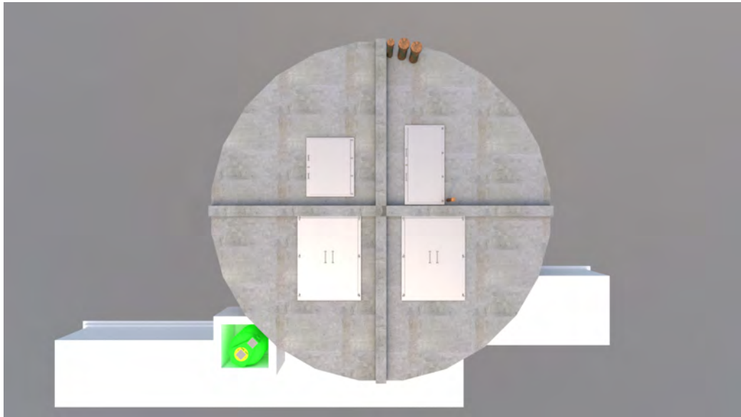
Figura 12.18: Vista in pianta del locale centrale e delle botole metalliche poste sul solaio di copertura.
