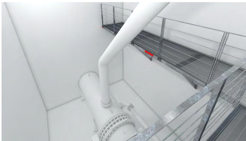
**Figura 3.9:** *Vista assonometrica della camera valvole. In primo piano la valvola di guardia condotta e lo sfiato. Sullo sfondo la passerella metallica in cui verranno posizionati i quadri elettrici di comando e controllo e la centralina oleodinamica.*
