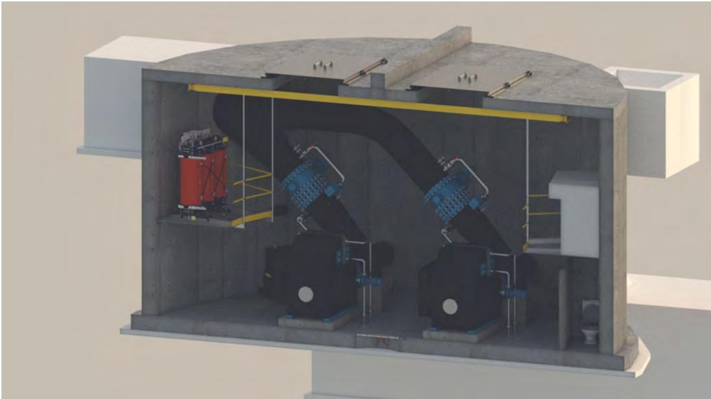
**Figura 3.19:** Spaccato assonometrico del locale centrale, sulla sinistra si osservano i trasformatori in resina, al centro i due gruppi di produzione Francis.
