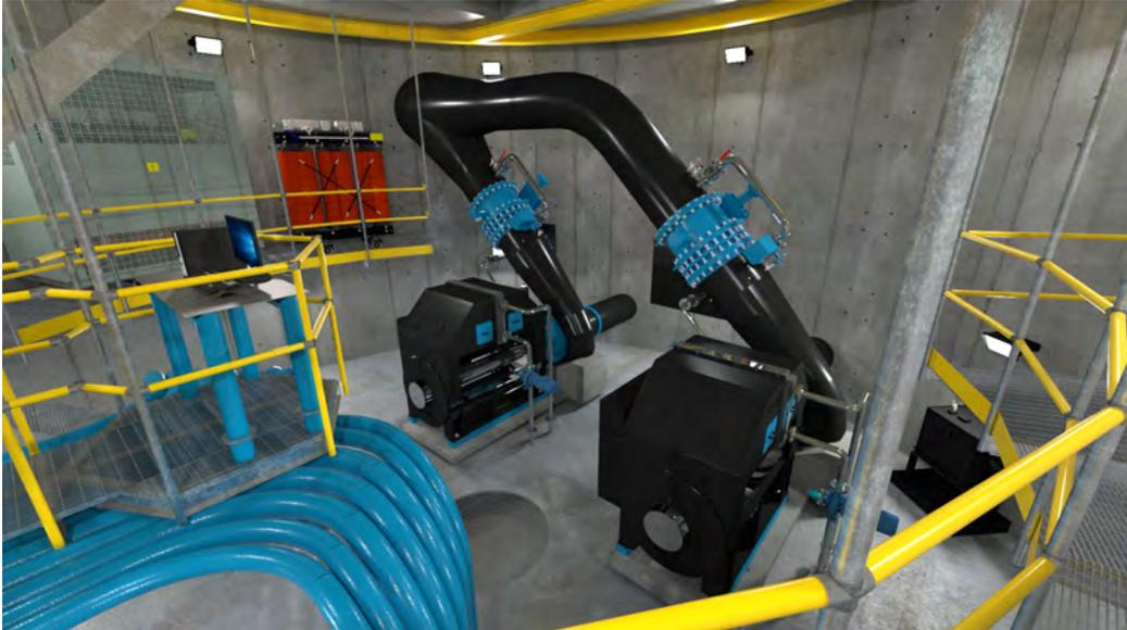
**Figura 3.15:** *Vista assonometrica dell'interno del locale centrale Sulla sinistra il pulpito con il PC di controllo dell'impianto, sullo sfondo i due gruppi di produzione Francis.*
