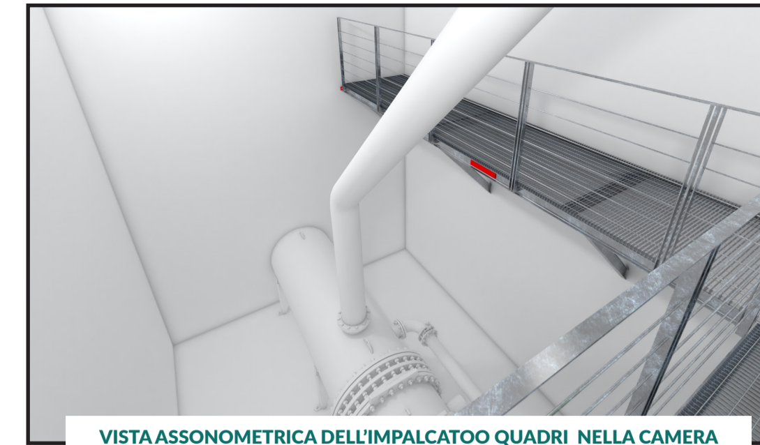
VISTA ASSONOMETRICA DELL'IMPALCATO QUADRI NELLA CAMERA VALVOLE. IN PRIMO PIANO LO SFIATO DELLA CONDOTTA FORZATA
