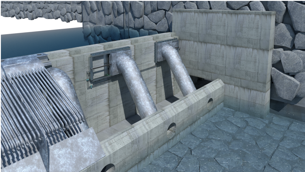
Figura 2.1: Vista assometrica dell'opera di presa con in primo piano le tubazioni di rilascio del DMV.
