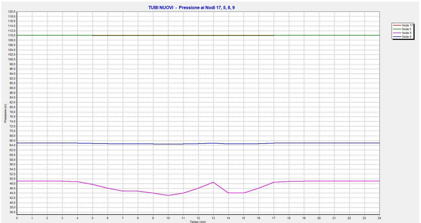
Output di calcolo (TUBI NUOVI): pressione ai nodi 17, 5, 8 e 9 nell'arco della giornata
