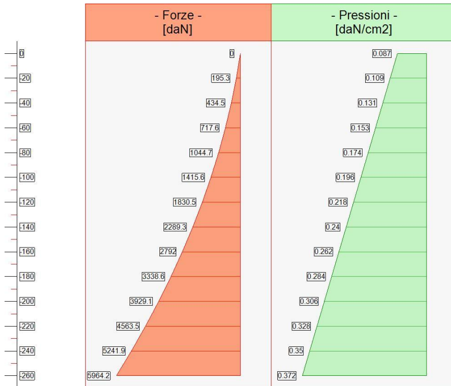
Forze (totali) e Pressioni lungo il fusto, per il Caso 7 (FREQ. [Frequente] - SLE frequente)
