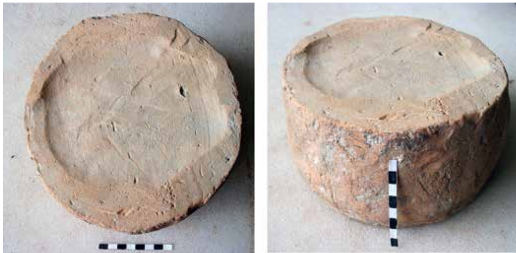
Fig. 24. Aosta, Terme del Foro, laterizio circolare tipo 1 con tracce di lisciatura sulle superfici esterne (G. Amabili, su concessione della Regione autonoma Valle d'Aosta).
