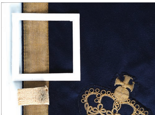
17. Prova di pulitura meccanica con gomma. (C. Pagliero)
