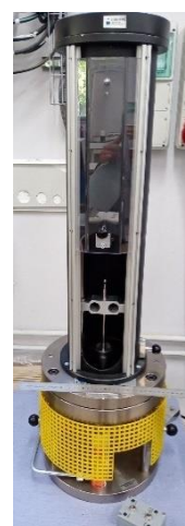
Perforation dynamique (procédure adaptée de la norme EN ISO 13433) Perforazione dinamica (procedura adattata da EN ISO 13433)
