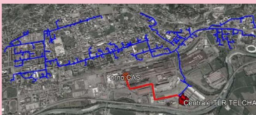
Un esempio virtuoso e innovativo di recupero dei cascami termici industriali è quello del collegamento dell'impianto di teleriscaldamento di Aosta con lo stabilimento siderurgico CAS (d.G.c. 264/2022) finalizzato a fornire calore da immettere nella rete. Il progetto consiste nel modificare l'attuale sistema di raffreddamento dei fumi di scarico dei forni fusori e nel realizzare nuovi scambiatori al fine di
