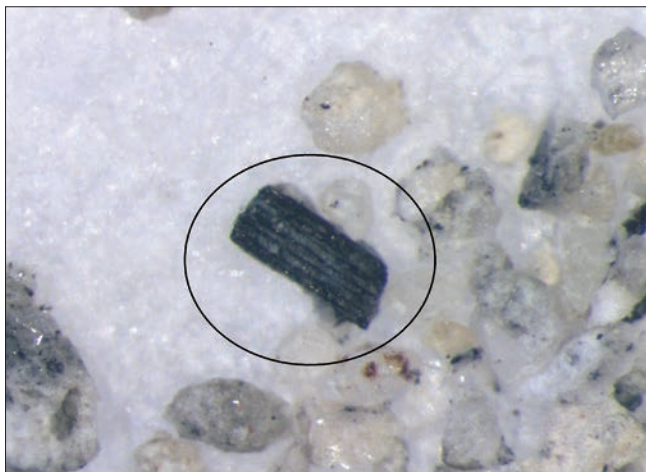
2. Frammento di un carbone di legna osservato allo stereomicroscopio a 25X. (D. Vandan)
