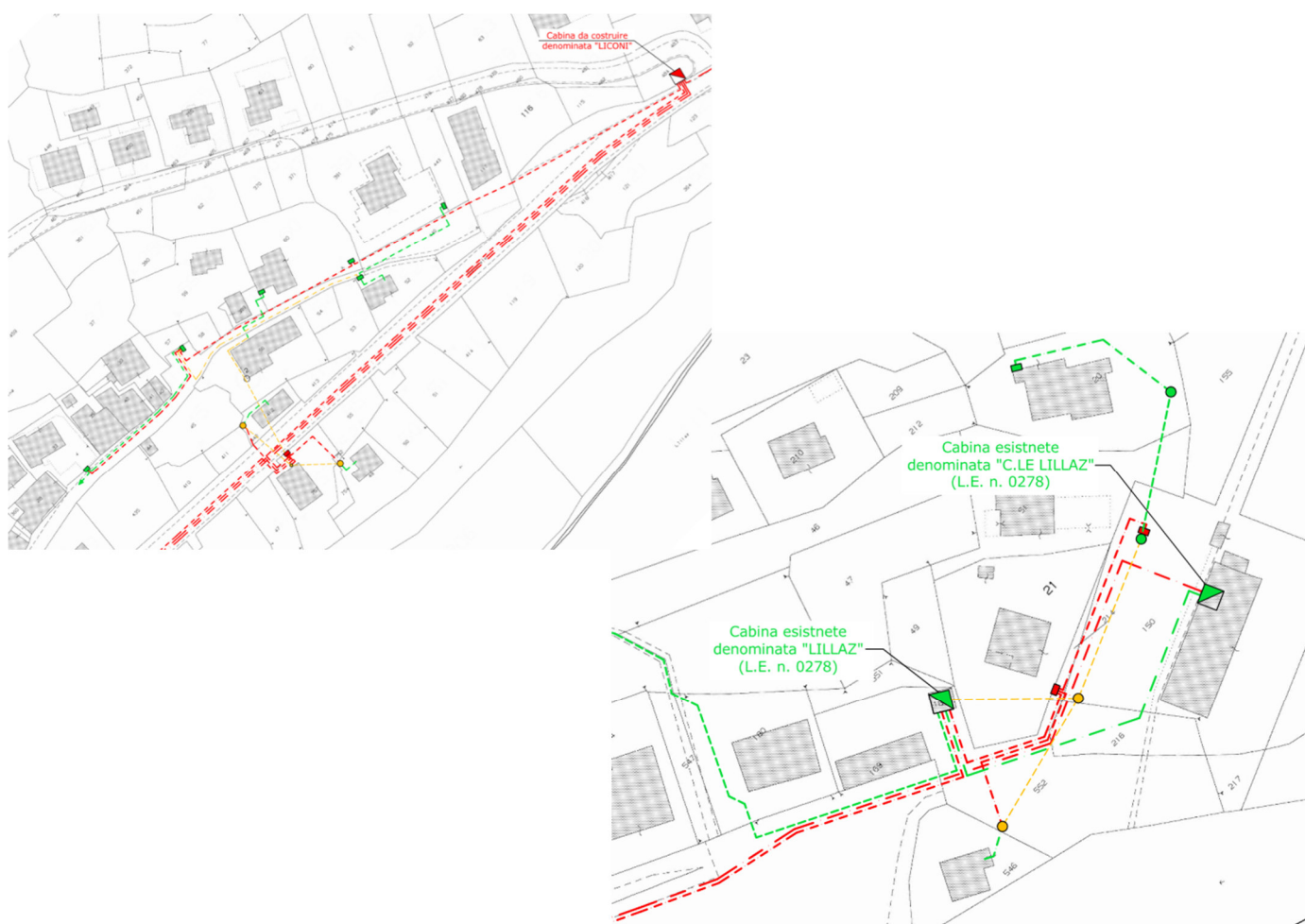
Figura 2 – Posizione dei tratti di linea aerea esistenti (indicati in giallo) che verranno dismessi. I tratti di linea sono ubicati nei villaggi di Moline (dx) e di Lillaz (sn).
