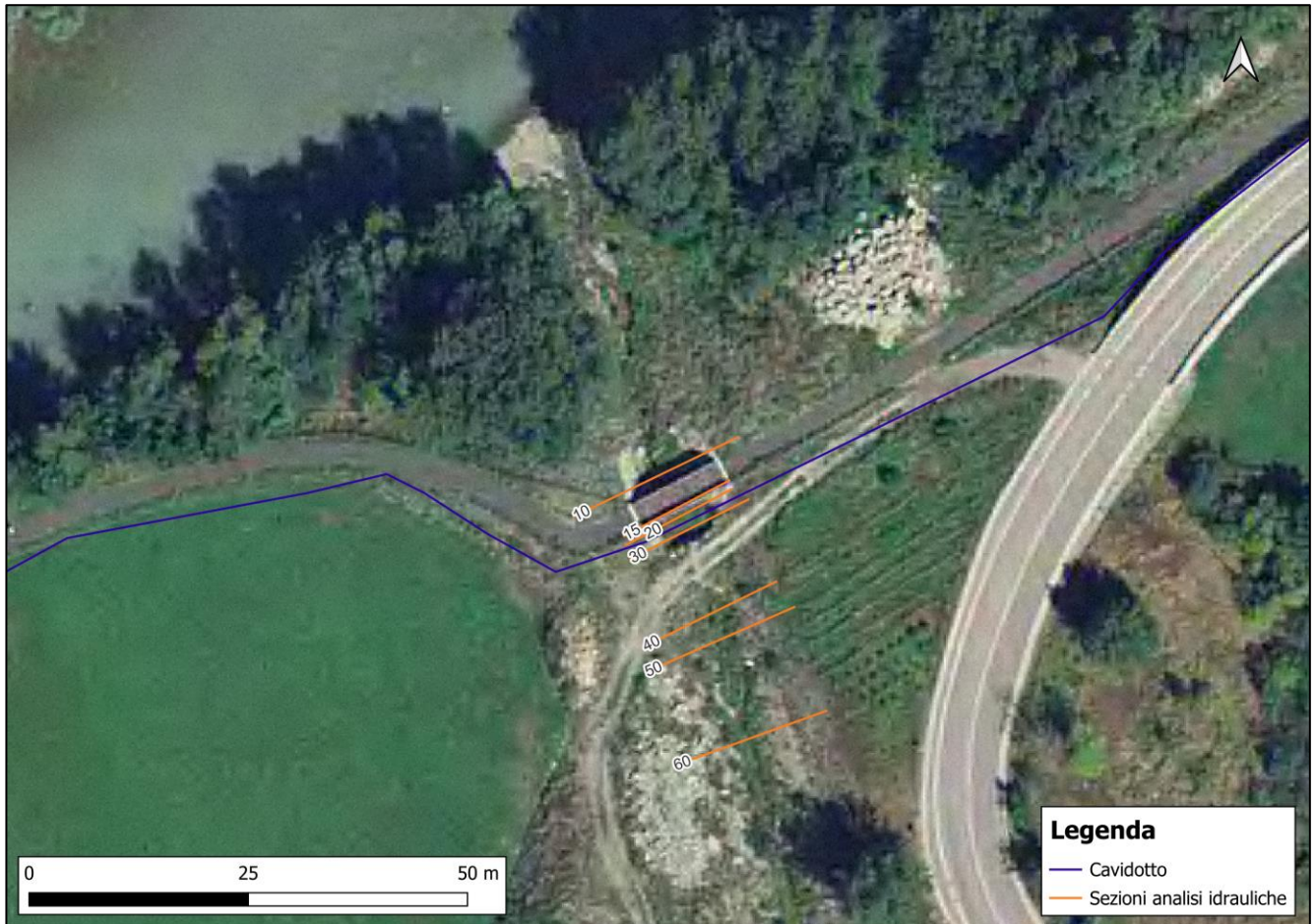
Figura 31: Ubicazione delle sezioni lungo l'alveo del torrente Grand Val utilizzate per le verifiche idrauliche.
