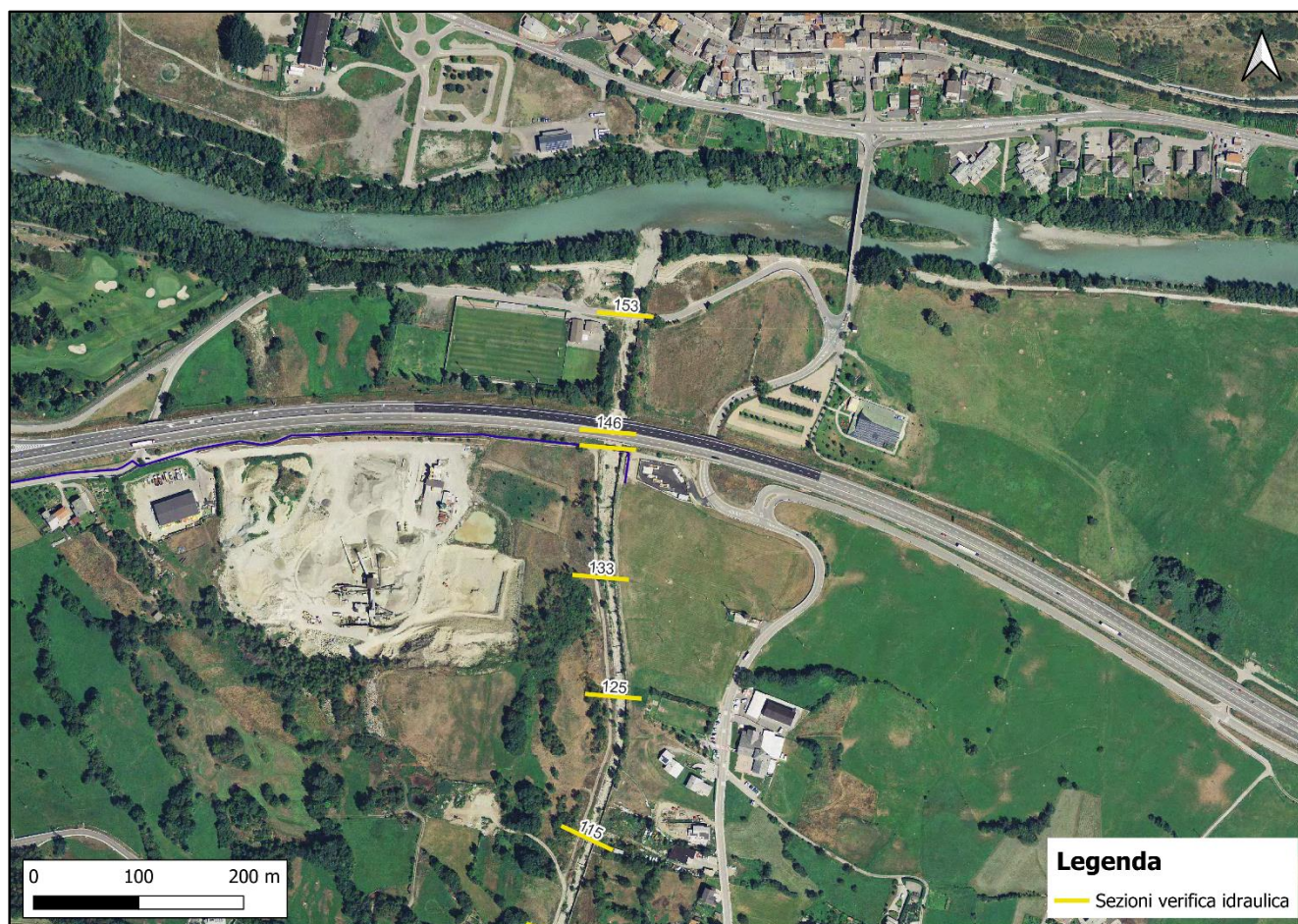
Figura 34: Sezioni per le verifiche idrauliche lungo il torrente Les Laures. Tutte le sezioni presentano un franco superiore al metro, tranne la n. 125, che presenta un franco di 0.42 m.
