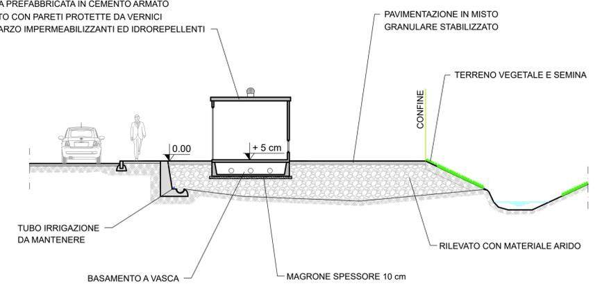
ABBASSAMENTO MARCIAPIEDE A QUOTA STRADA PER REALIZZAZIONE ACCESSO CARRAIO
