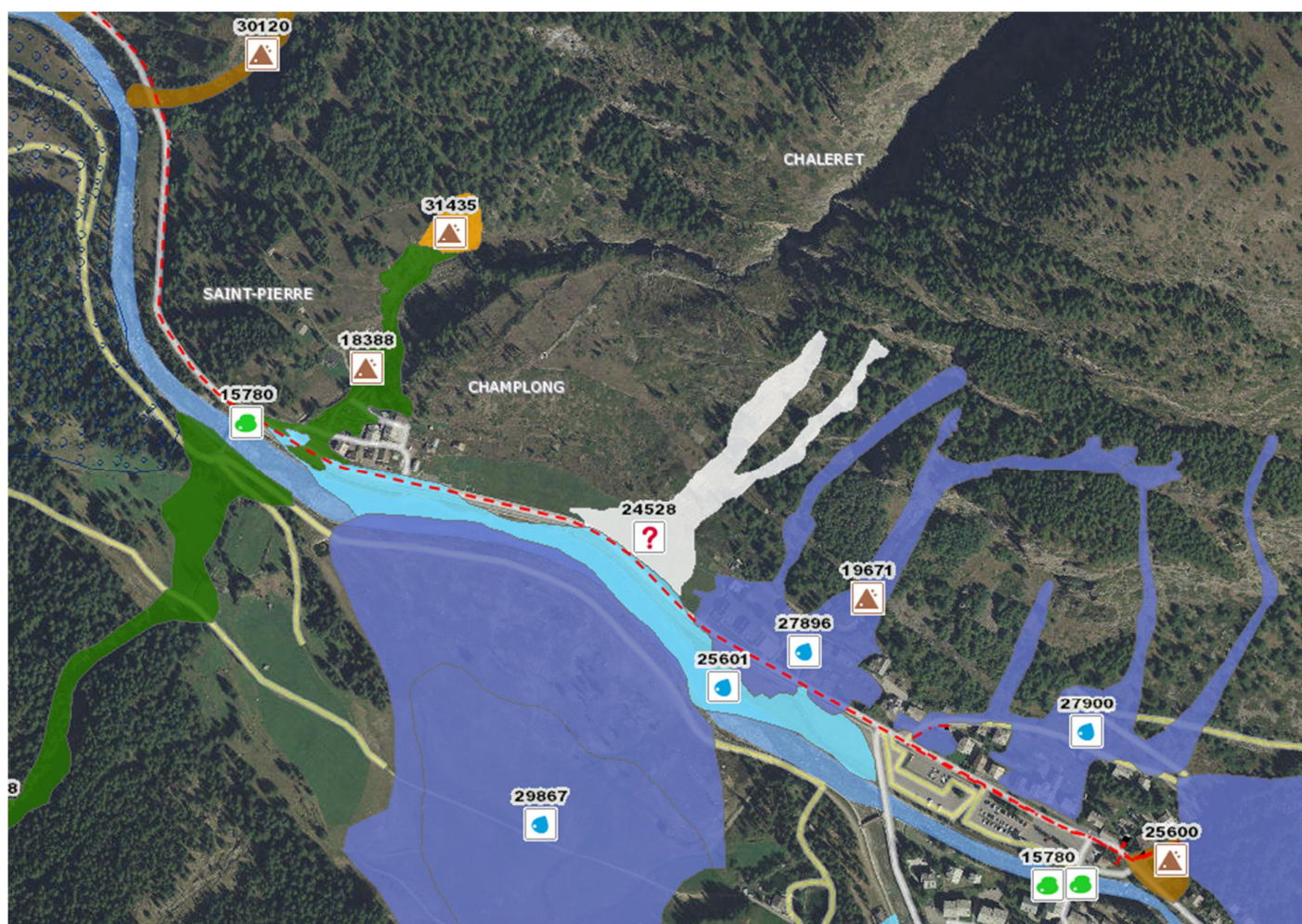
Figura 14 – Dettaglio cartografico del tratto di valle della condotta interrata con ubicazione dei dissesti censiti.
