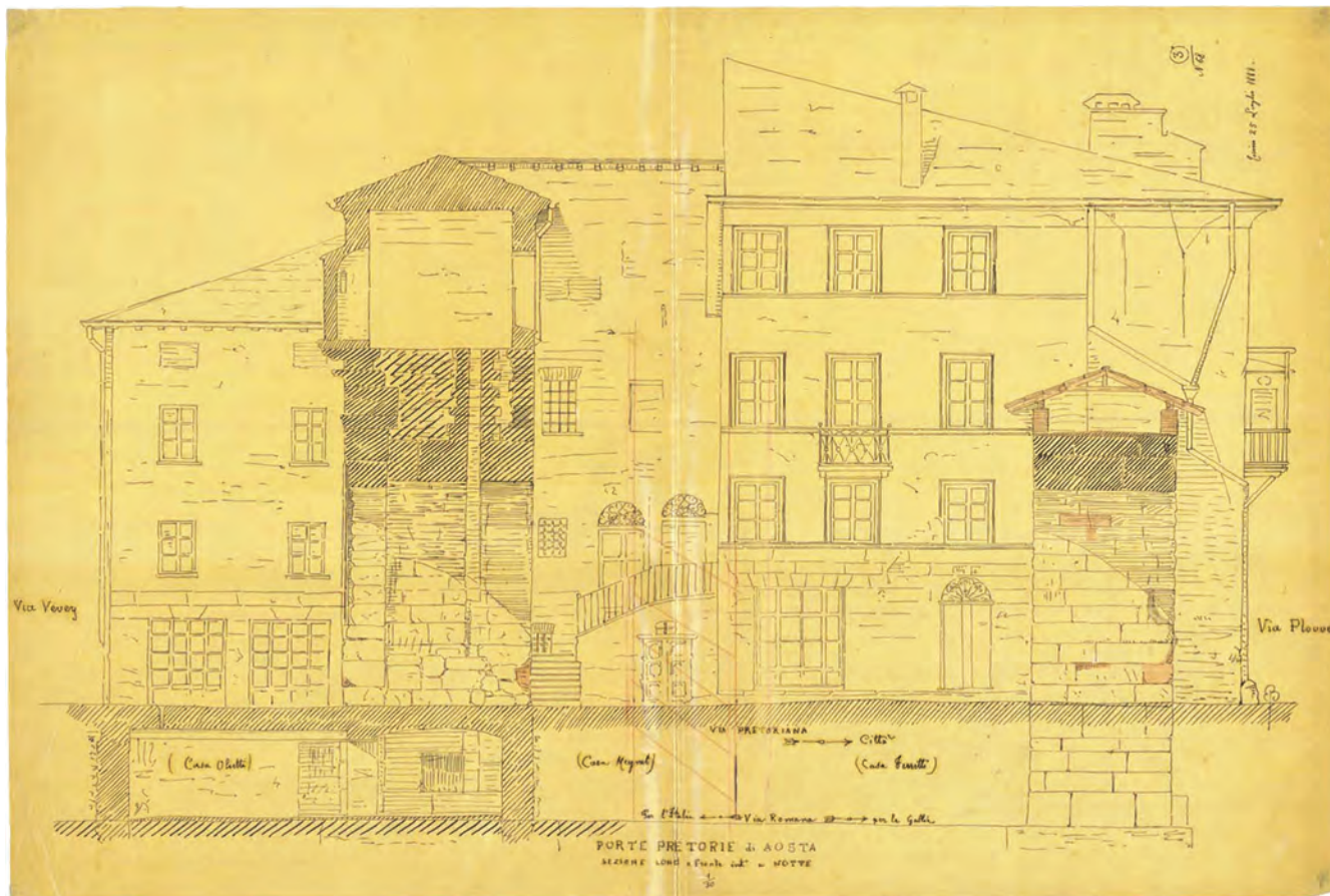
14. Disegno di Alfredo d'Andrade della Porta Prætoria, fine XIX secolo: sezione e prospetto settentrionale della torre sud con indicazione delle proprietà. (Archivi beni archeologici SBAC)
