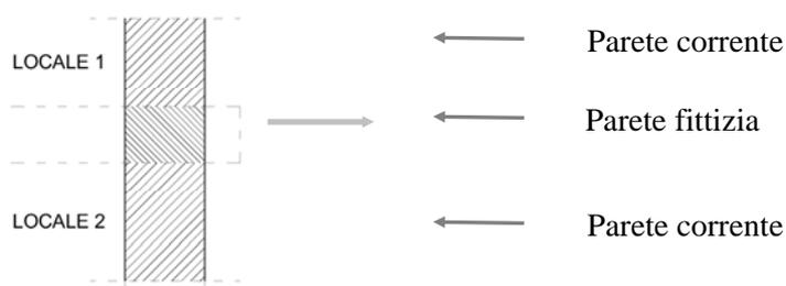
64. **ponte termico** è la discontinuità di isolamento termico che si può verificare in corrispondenza agli innesti di elementi strutturali (solai e pareti verticali o pareti verticali tra loro).
