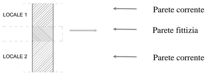
25. **ponte termico** è la discontinuità di isolamento termico che si può verificare in corrispondenza agli innesti di elementi strutturali (solai e pareti verticali o pareti verticali tra loro).
