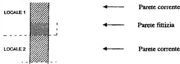
20. **ponte termico** è la discontinuità di isolamento termico che si può verificare in corrispondenza agli innesti di elementi strutturali (solai e pareti verticali o pareti verticali tra loro).
