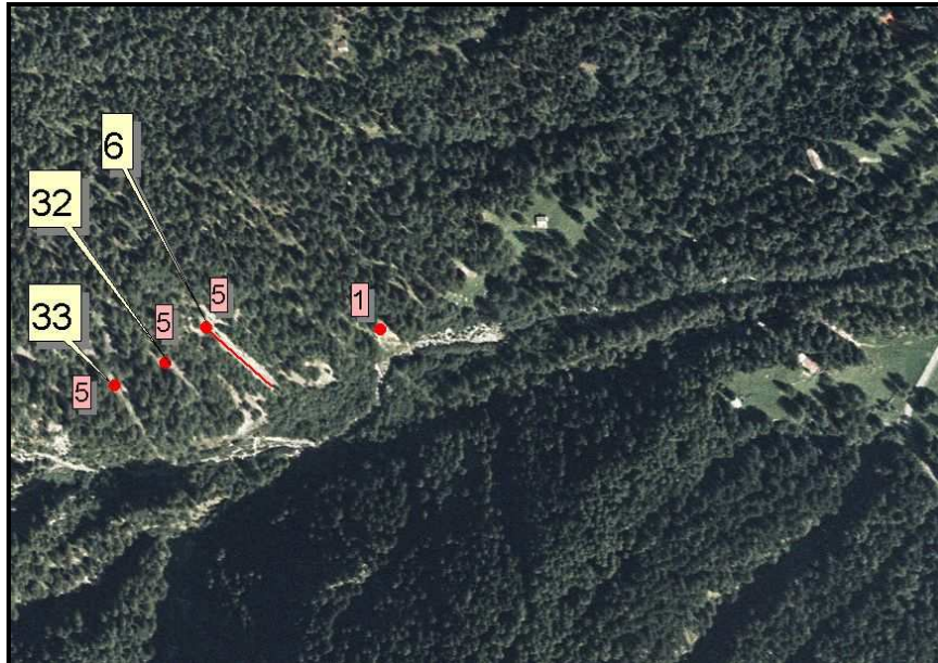
Figura 7: esempio di compilazione di frane puntuali (punto rosso) e lineari (punto rosso +linea). Le label di colore giallo indicano l'ID frana, quelle di colore rosso il tipo di movimento (secondo la codifica IFFI: 1 = crollo; 5 = colamento rapido).
