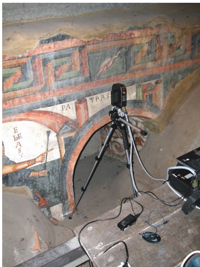
5. Spectrophotomètre en réflexion des rayons X portable, utilisé pour les analyses directes sur le monument. (L. Degani)
