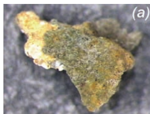
11. Photos du fragment (a - stéréo, 25x) et de la coupe (b - microscope minéralogique, 200x) de l'échantillon 16S1, dans la coupe on voit dans la couche superficielle (b) la présence de la résine synthétique (Mowhilit) employée dans les travaux des Années 60. (M. Ganio)
