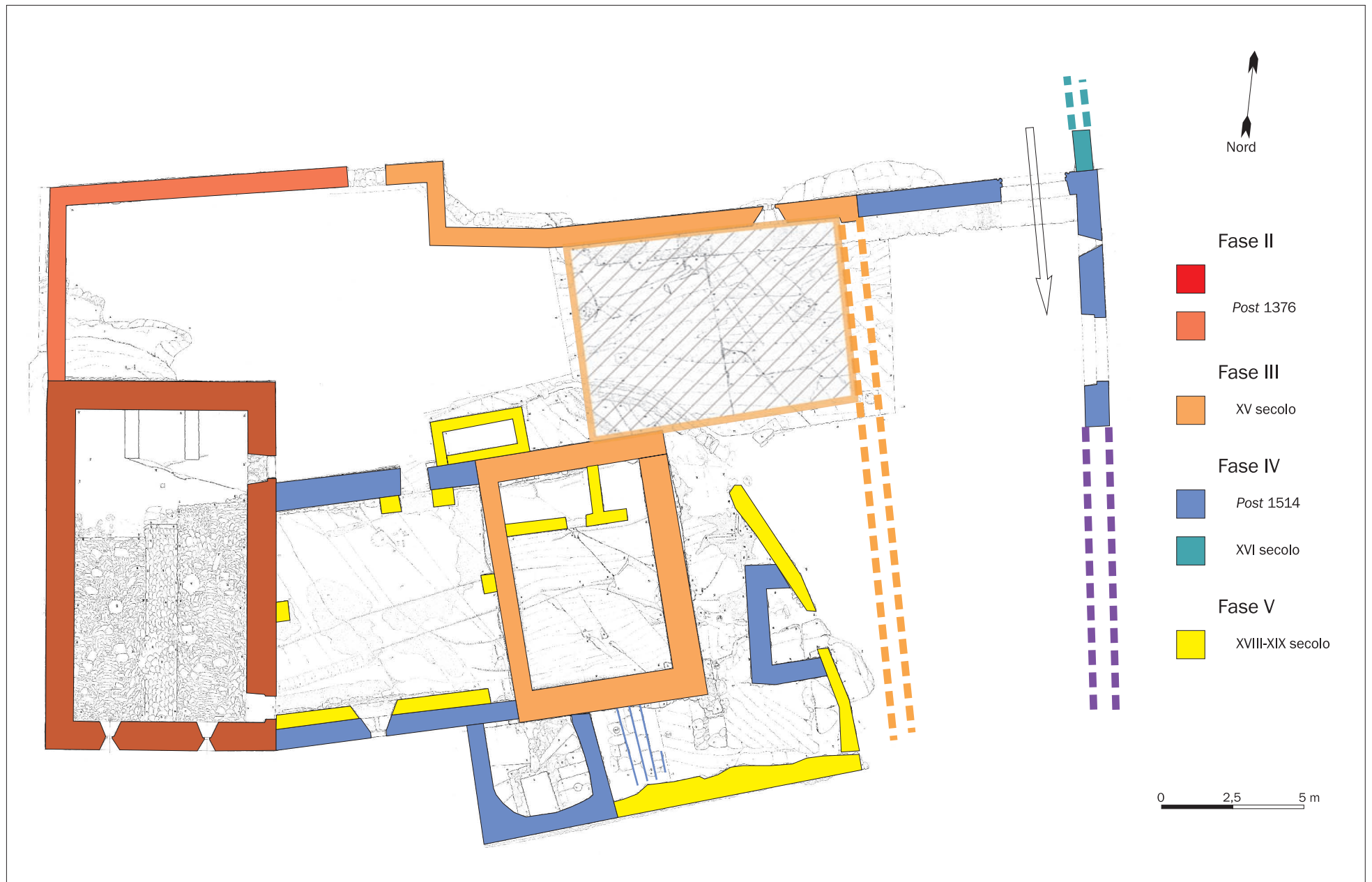
6. Pianta delle strutture con indicate le fasi costruttive. (Disegni G. Abrardi, elaborazione M. Cortelazzo)
