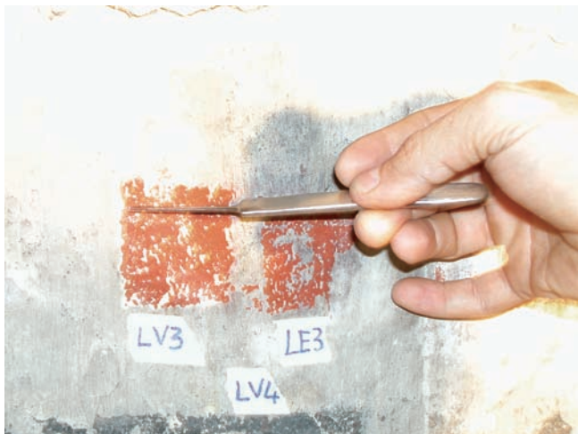
2. Immagine del punto di prelievo del campione V/O38, nella parte più interna è visibile il tassello ottenuto con un altro Laser. (D. Vandan)
