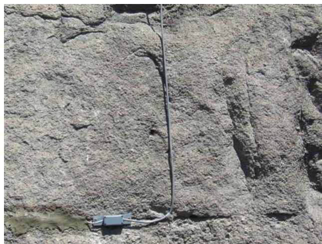
2. Sonde per la misura della temperatura a contatto poste nella parte centrale della parete. (A. Idone)
