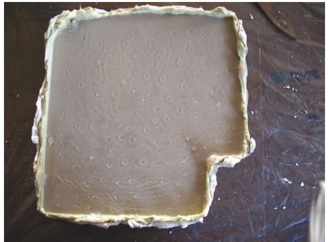
13. Le moule rempli de résine époxy chargée. (S. Pulga)
