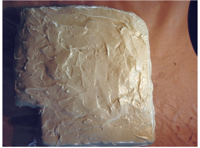
11. La pierre recouverte par la gomme siliconée pour réaliser le moulage. (S. Pulga)
