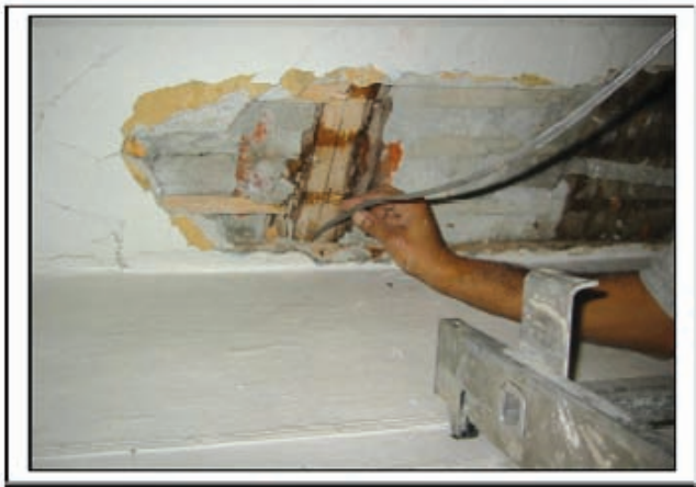
Esecuzione dell'indagine videoendoscopica n. 3
