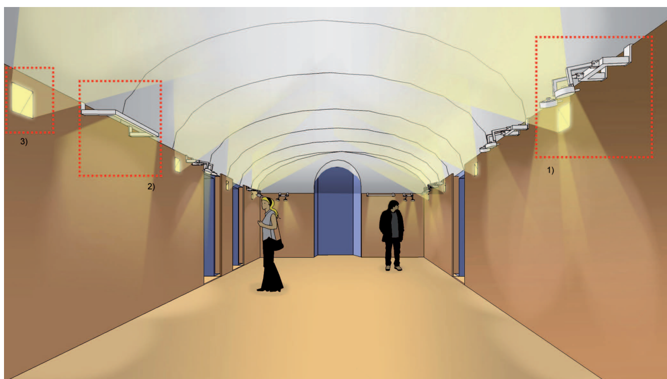
1) particolare di ancoraggio delle appliques fluorescenti alla controparete
