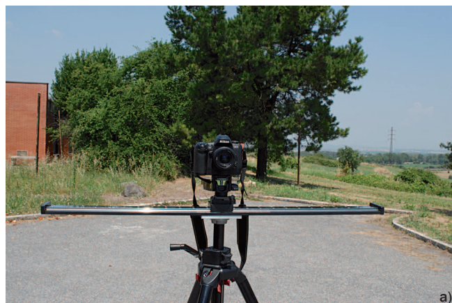
3. L'attrezzatura di acquisizione per il rilievo con risoluzione: a) alla scala architettonica, b) alla scala micrometrica. (P. Salonia)
