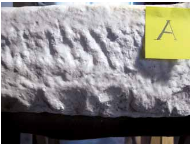
3. Tracce della sabbia usata per la sbazzatura. (S. Pulga)
