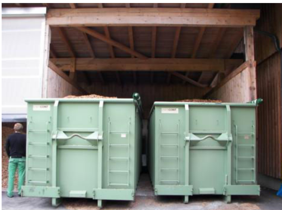
Figura 18 – Esempio di scarrabili per l'essiccazione del cippato
