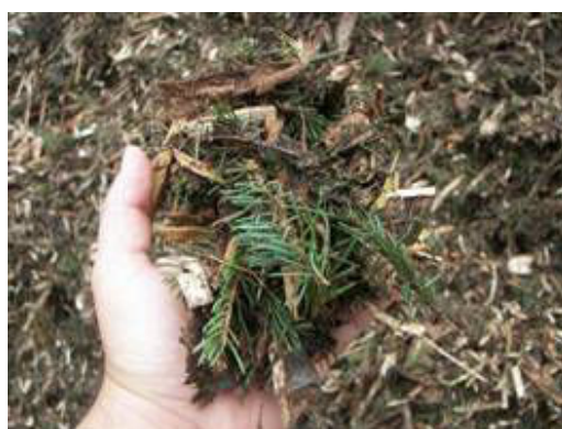
Figura 19 – Aspetto del cippato B, prodotto da ramaglie di conifere (abeti)
