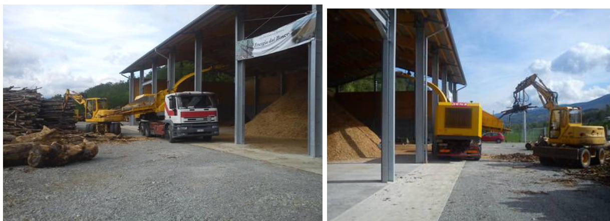
Figura 16 – Cippatura di stanghe e tronchi presso la piattaforma biomasse delle Comunali Parmensi (Borgotaro – Parma).
