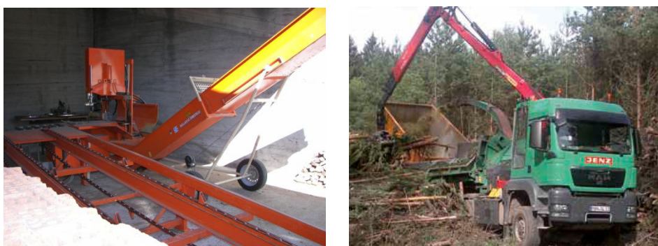
Figura 13 – tipologie di cippatrici
