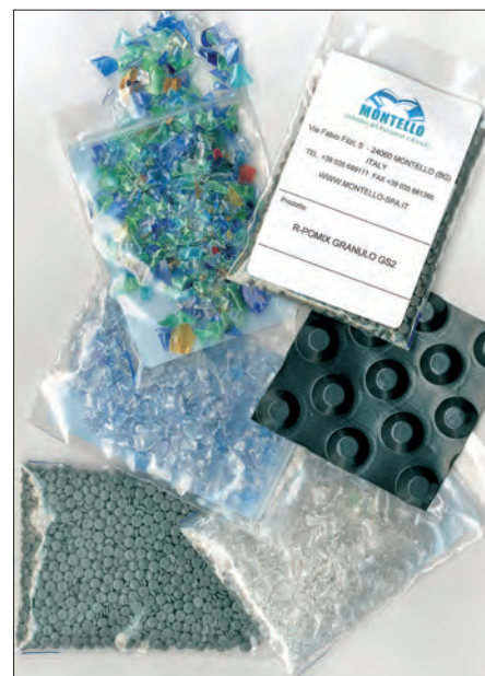
Materia prima seconda prodotta presso l'impianto di Montello a partire dalla raccolta differenziata delle plastiche.
