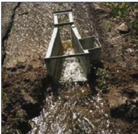
Figura 59 - Misuratore Parshall modificato dal USGS.
