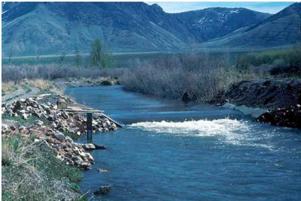
Figura 50 - Misuratore a risalto in funzione in un alveo naturale, vista da valle verso monte.
