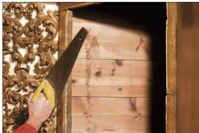
14. Esempio di lavorazione nella creazione degli sfondati per inserire le scene ad altorilievo. (Pm. Reboulaz)
