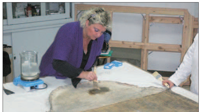
19. L'avvio del consolidamento dal retro. Sulla sinistra dell'immagine è visibile l'agitatore magnetico riscaldante, su cui è poggiato il recipiente che contiene la resina termoplastica in soluzione. (L. Pizzi)
