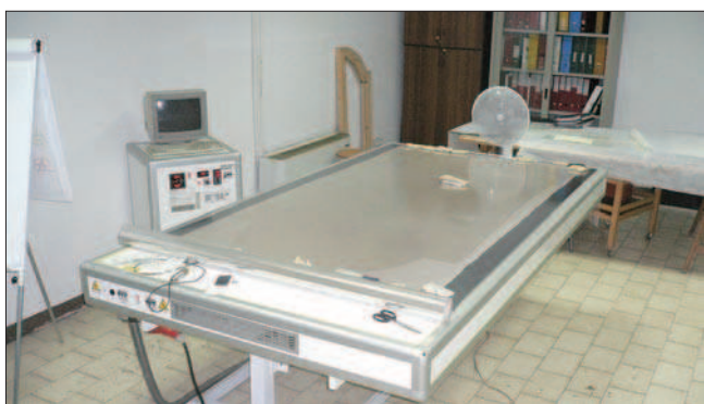
24. La foderatura in corso sulla tavola calda e aspirante del dipinto raffigurante i santi Martino e Cristoforo e la Sacra Sindone. (L. Pizzi)
