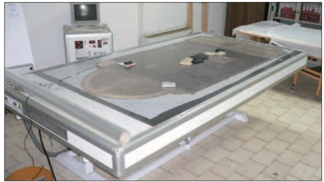
18. Sulla tavola calda aspirante, il consolidamento degli strati pittorici e il ristabilimento del planarità del supporto tessile. (L. Pizzi)
