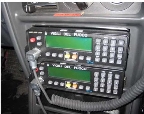
Sono stati inoltre installati sugli automezzi generalmente impiegati per interventi in galleria degli apparati radio con banda a 400 MHz collegati, tramite cavo seriale, ad apparati radio con banda a 73 MHz. Posizionando un veicolo così allestito, denominato "transponder", all'imbocco di una galleria autostradale, si ha la possibilità di mettere in comunicazione il personale che si
