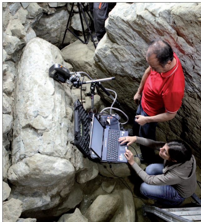
16. Analisi mediante spettrofotometria XRF delle tracce di pigmento rinvenute sull'intonaco della T. 10 prima del suo smontaggio. (A. Glarey)
