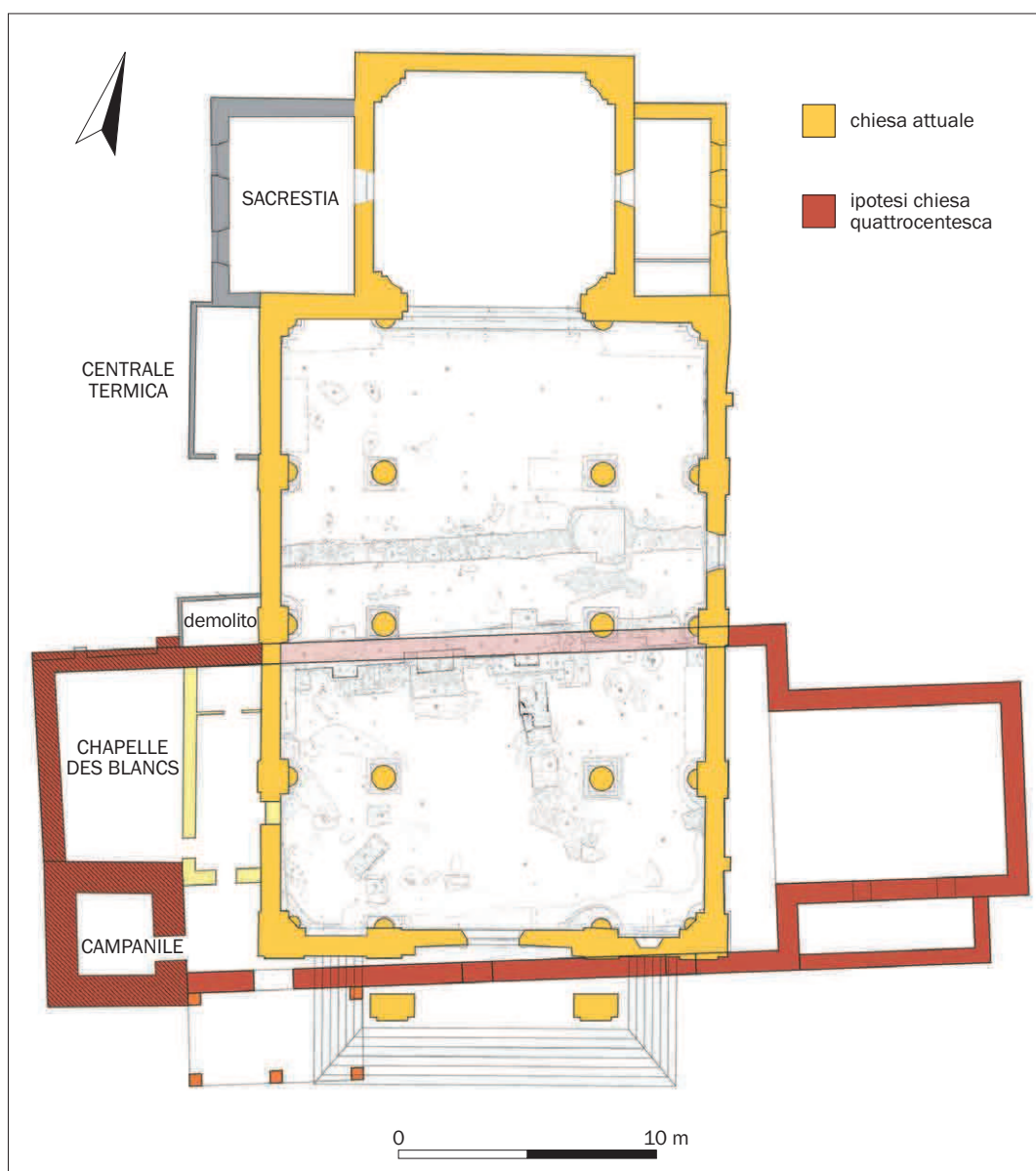
2. Sovrapposizione ipotetica elaborata prima dell'inizio delle indagini archeologiche tra la pianta della chiesa barocca e quella della chiesa tardomedievale: in filigrana il posizionamento delle strutture effettivamente emerse a fine scavo. (Rilievo M. Lévêque, G. Abrardi, elaborazione M. Lévêque, M. Cortelazzo)
