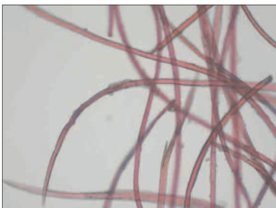
4. Fibre di seta trattate osservate al microscopio ottico in luce trasmessa, 200x.
