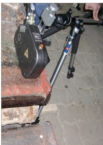
1. Testa analitica dello strumento XRF durante l'analisi dei pannelli. (S. Cheney)
