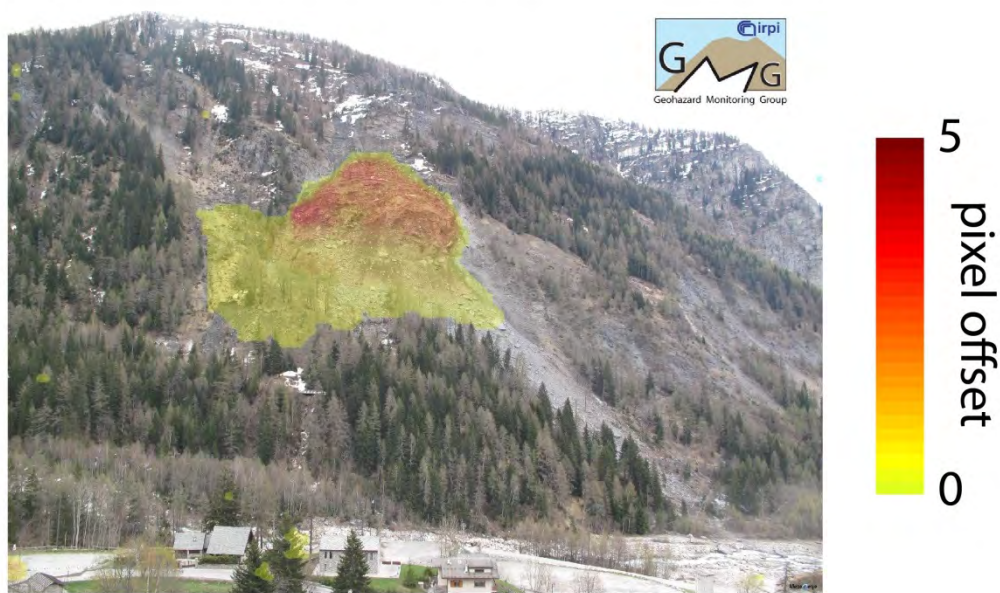
Figura 6.4 elaborazioni pixel offset dell'area in frana. Come si evince dall'immagine in alto, queste elaborazioni possono essere svolte solamente in contesti in cui venga mantenuta una certa congruenza nella sequenza di immagini. Nel trimestre considerato, quindi, l'analisi su lunghi periodi non può essere condotta a causa dei crolli che modificano in maniera radicale la geometria dell'oggetto monitorato.
