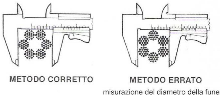
**Figura 18 – Metodo di misurazione del diametro delle funi**
