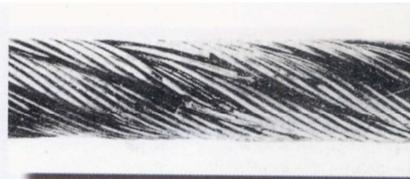
Fili rotti in un trefolo unitamente ad una lieve usura, in una fune ad avvolgimento parallelo (Tenere la fune sotto controllo, togliere i fili spezzati in modo che le estremità siano a raso del profilo esterno).
