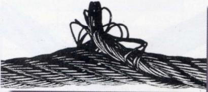
Espulsione dell'anima metallica, generalmente associata ad una deformazione a canestro nella zona adiacente. (Sostituire immediatamente la fune).
