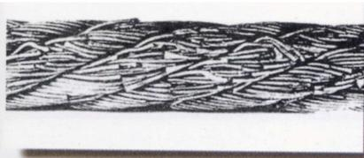
Notevole numero di fili rotti, unitamente ad una grave usura, in una fune ad avvolgimento crociato. (Sostituire immediatamente la fune).
