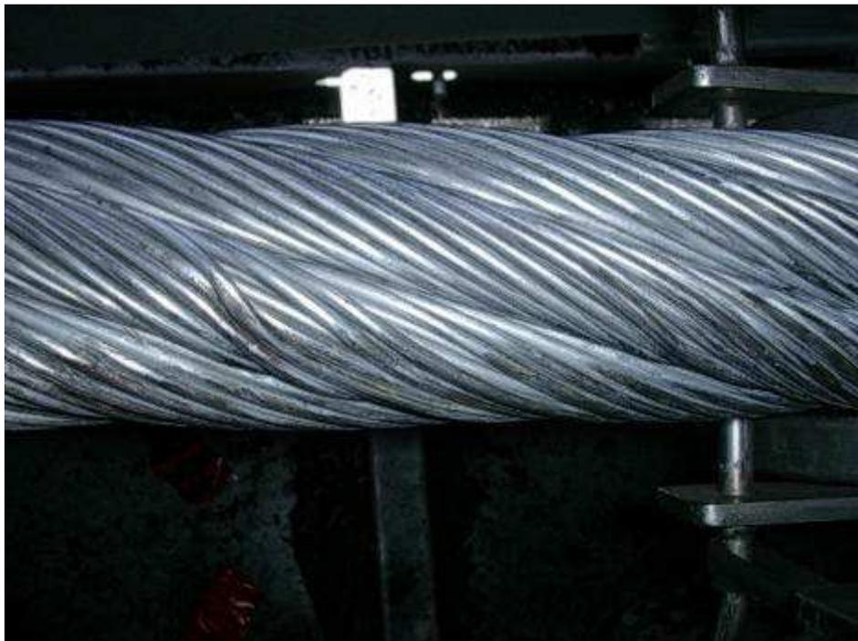
**Figura 25 - Deformazione meccanica**
