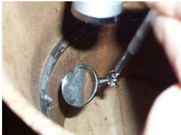
Figura 8 – Esame visivo sulla saldatura di una tubazione
