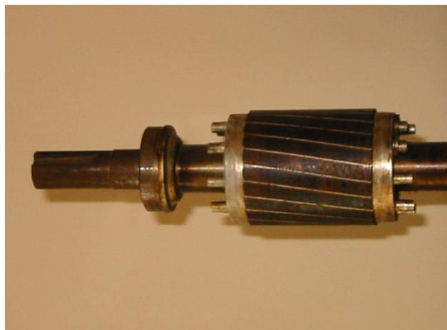
Figura 26 – Rotore del MAT del tipo “a gabbia di scoiattolo”
