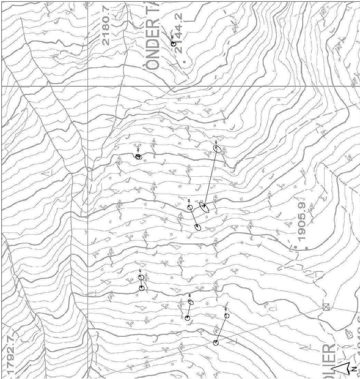
Figura n. 9: vettori di spostamento GPS a lettura manuale.
