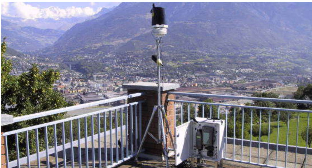
Figura 3 – Foto di una postazione fonometrica rilocabile
