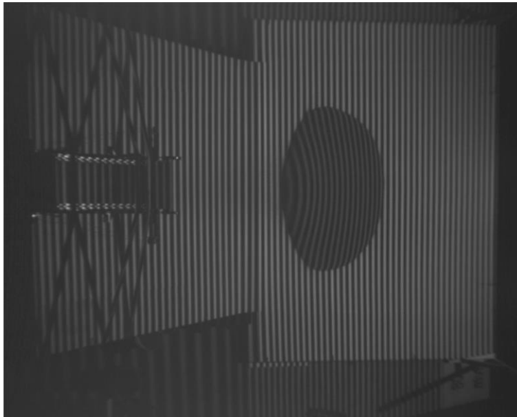
Figure 2 : Dépôt résultant d'un lâcher de 100 litres de gravier depuis 1 mètre de hauteur sur un plan incliné à 45° terminé par une transition courbe de 25 cm de rayon. Distorsion des franges sinusoidales projetées sur le dépôt (photo à gauche) et résultat du traitement d'images (graphe à droite).
