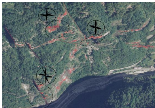
Figura 3 – Sistemi di discontinuità (linee rosse) e diagrammi a rosa dei settori a maggiore densità di fratturazione (cerchi neri tratteggiati). I sistemi di frattura mostrano una direzione media N-S, E-W e WNW-ESE.
