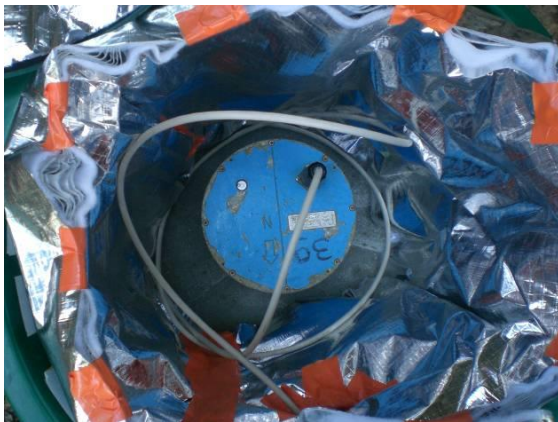
Figure 15 Photo d'un capteur sismique Lennartz 3C 5s installé sur le site de La Praz.
