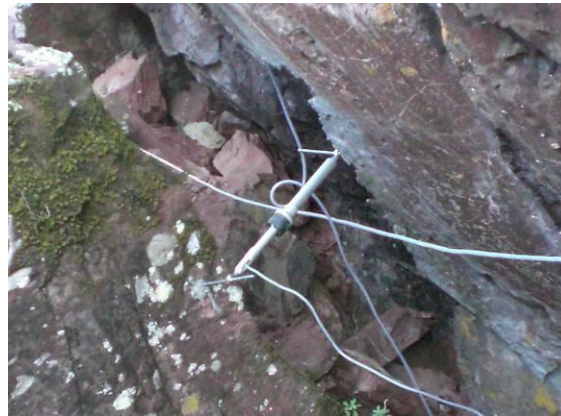
Figure 16 Photo d'un extensomètre à piston installé sur le site de Rubi.
