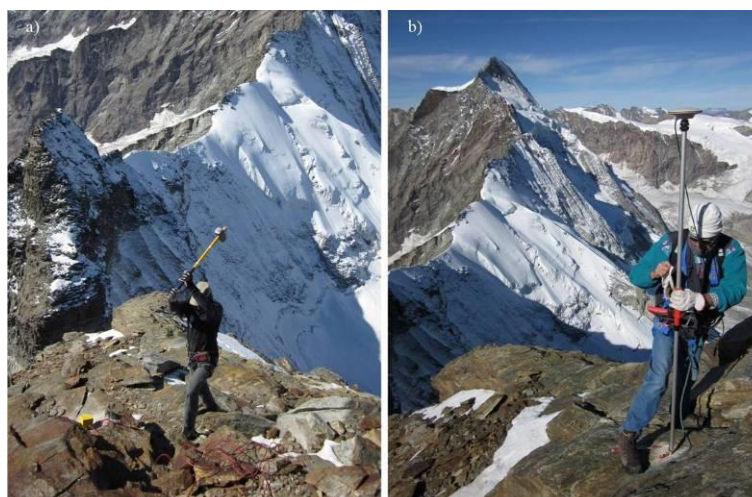
Figure 21 Tests de calibration du système: a) coup de marteau; b) géo-référencement du point (photos: CNR IRPI Torino).
