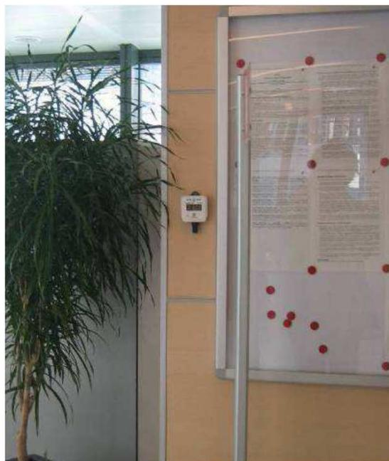
Lo strumento si applica a parete e rende traccia di temperature e umidità rilevate a cadenza regolare (ad esempio, può essere tarato per rilevare ogni minuto o ogni ora) e conservare il dato per molte rilevazioni, sino al momento in cui il dato viene esportato da opportuni software e restituito secondo forma di grafico o tabella.
