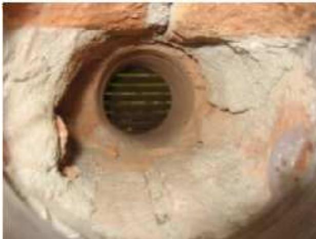
Il caso limite di indagine delle strutture, è il tipo invasivo. Si tratta di ricercare la composizione tramite un foro praticato in posizione non visibile (e poi richiuso) e l'utilizzo di una telecamera a filo da cui si possono identificare i principali componenti della struttura.
