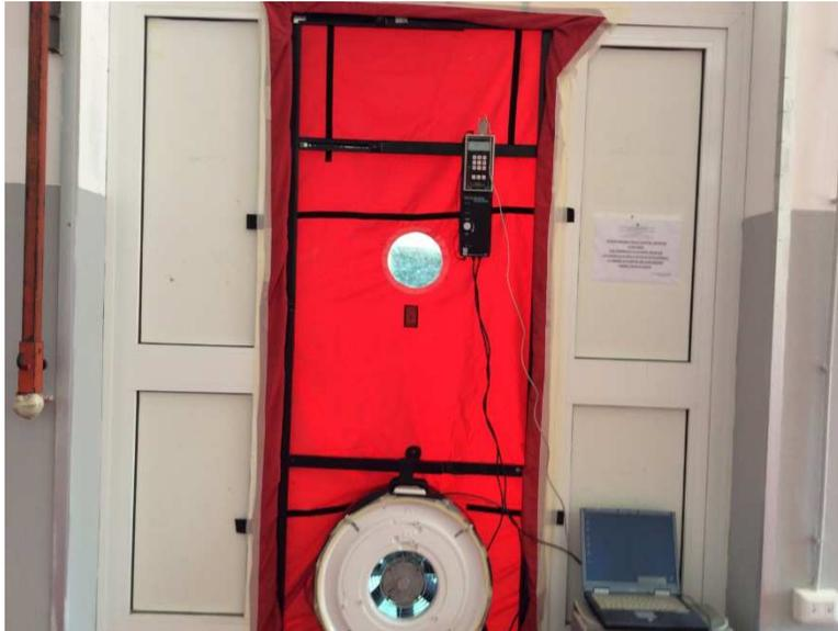
La macchina per il test e la sua applicazione su una delle porte dell'ambiente di studio
