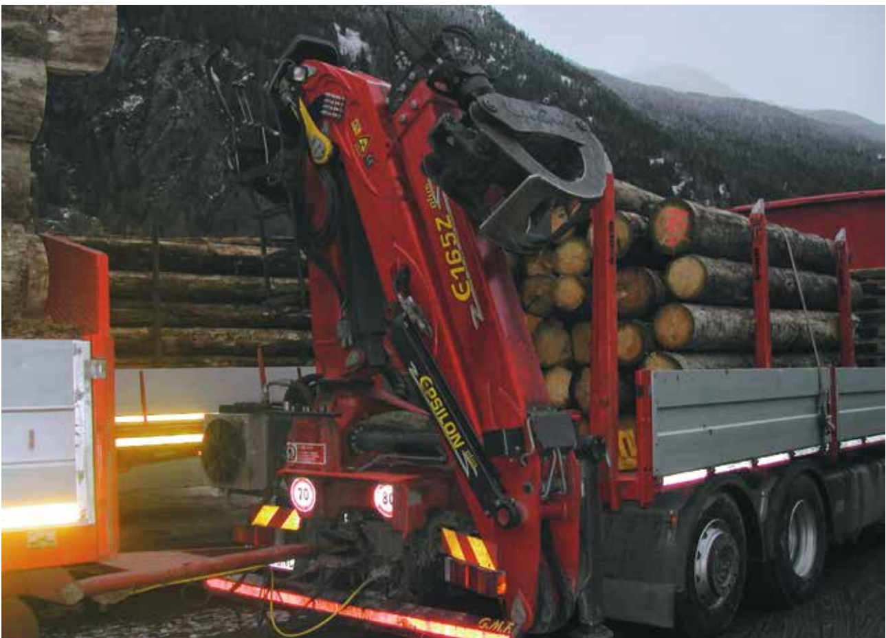
Attrezzatura finanziabile dalla misura 8.6: cassone fisso con sponde in alluminio e piantoni in acciaio e caricatore completo di pinza per movimentazione tronchi.
