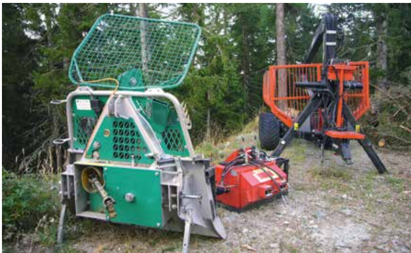
Attrezzatura finanziabile dalla misura 8.6: macchina portacavo e verricello forestale per esbosco e rimorchio forestale equipaggiato con caricatore forestale.
