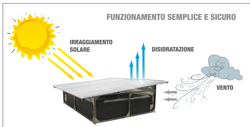
Schema del funzionamento di Heliosec®
