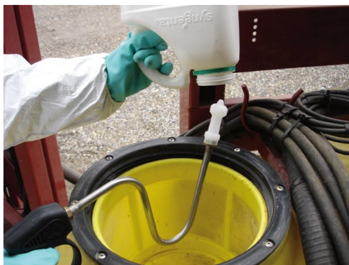
Sistema per il lavaggio interno dei barattoli (Rinçotop®)
