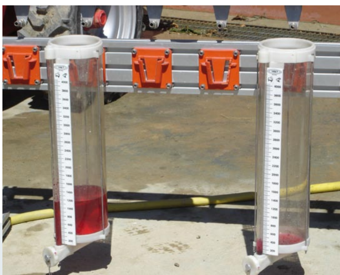
Misurazione della portata degli ugelli
