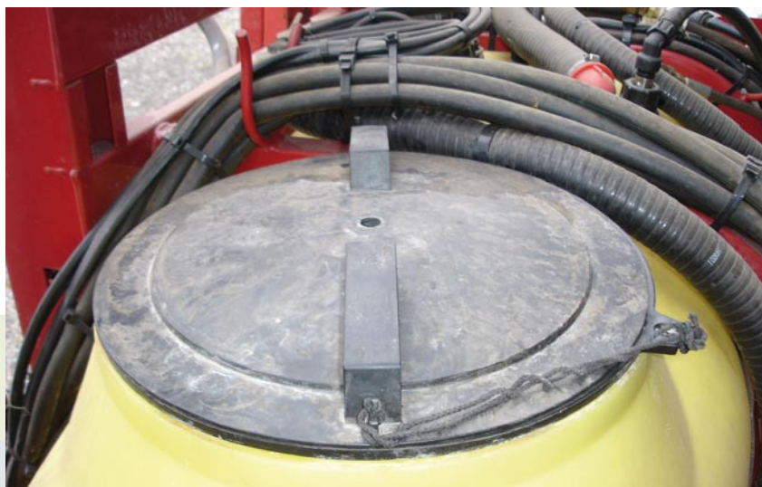
Coperchio serbatoio irroratrice adeguatamente chiuso
