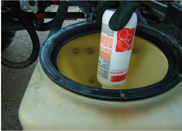
Risciacquo del contenitore mediante ugello lavabarattoli situato nel premiscelatore
