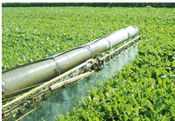
Barra irroratrice con manica d'aria attiva
