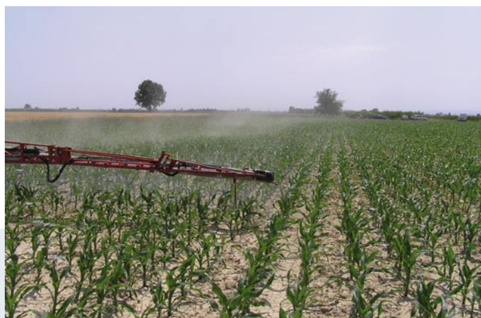
Deriva di prodotto fitosanitario da una barra irroratrice
