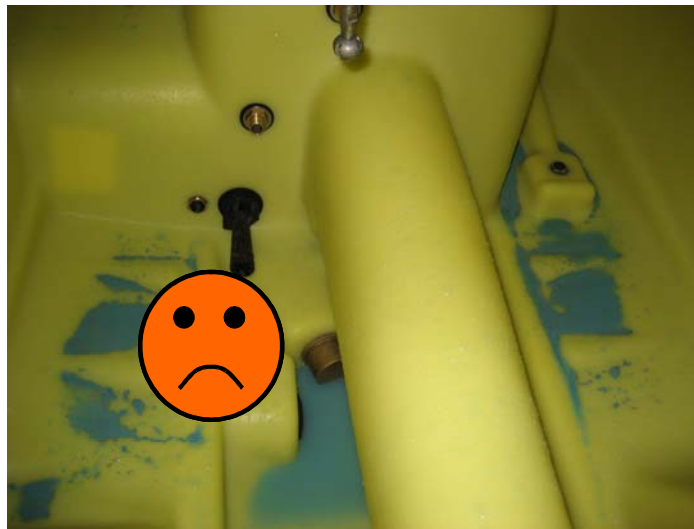
Fig. 24 – Miscela residua nel serbatoio poiché non aspirata dalla pompa (foto E. Nilsson – Visavi)
