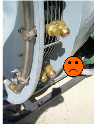
Fig. 21 - Esempio di ugello NON dotato di dispositivi antigoccia (sinistra) e di antigoccia non funzionante (destra).
