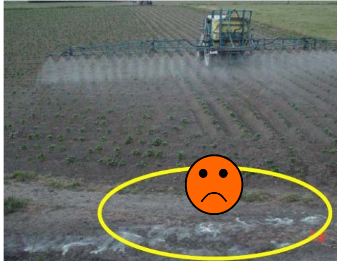
Fig. 45 – Effetto della distribuzione con irroratrice ferma (foto Phytofar)
