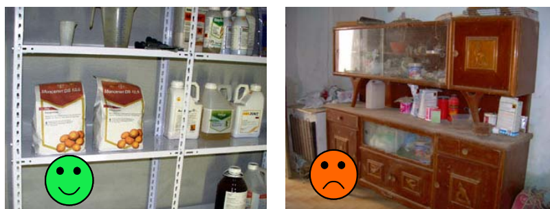
Fig. 9 - Uso di scaffalature facilmente lavabili e ignifughe e prive di spigoli taglienti (sinistra) e di armadio non idoneo con materiale assorbente e non ignifugo (destra)
