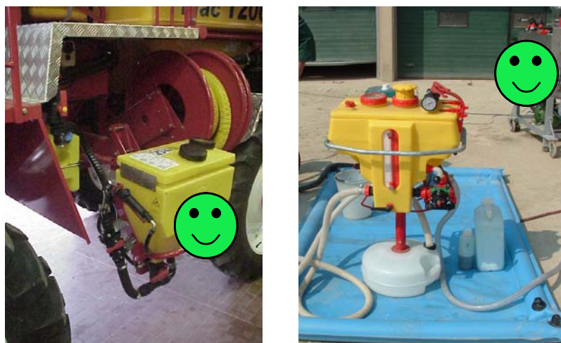
Fig. 39 – I premiscelatori possono essere montati direttamente sull'irroratrice (sinistra) oppure indipendenti (destra) ed alimentati direttamente dalla rete idrica dell'acquedotto.
