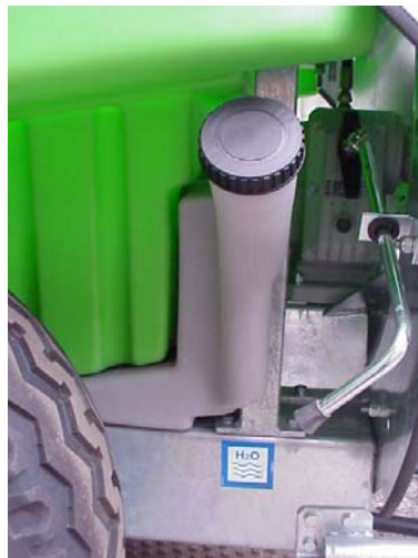
Fig. 26 – Il serbatoio lavaimpianto deve avere almeno il 10% della capacità nominale del serbatoio principale o almeno 10 volte il volume diluibile. La sua presenza consente di effettuare in campo il lavaggio dell'irroratrice e lo smaltimento della miscela residua nel serbatoio principale. Deve essere progettato in modo da consentire il risciacquo delle tubazioni anche con il serbatoio principale pieno e la diluizione del residuo all'interno dello stesso.
