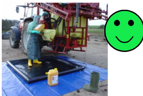
Fig. 37 – Attrezzature atta ad evitare perdite di prodotto durante la preparazione della miscela fitoiatrica (foto Spillsave).
