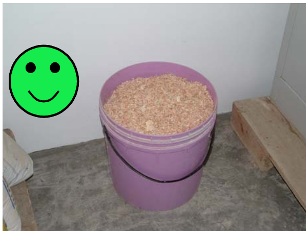
Fig. 14 – Esempio di materiale assorbente (in questo caso segatura) per tamponare eventuali perdite accidentali di prodotto nel magazzino di stoccaggio.
